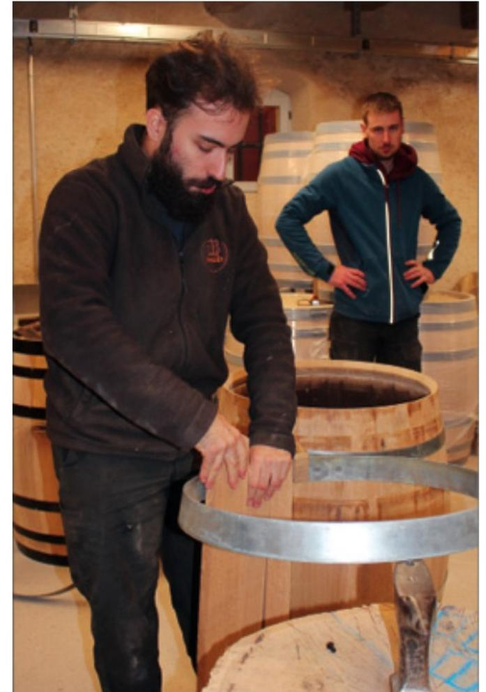
Mise en place des merrains formant les parois du tonneau.
